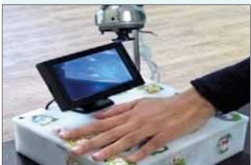
پژوهشگران دانشگاه علم و صنعت ایران با به کارگیری فناوری دوربین‌های دید در شب موفق به ساخت دستگاه رگ‌یاب دست اطفال شده‌اند که می‌تواند به مشکل پرستاران در تزریق به دست بیماران خردسال پایان دهد.
